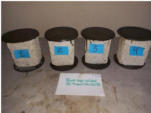
Imagen 1. Muestras de block de concreto macizo de baja calidad
